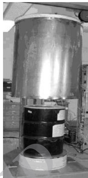
شکل ۴- تصویر یک LVC با یک گرماسنج در وضعیت بالایی بعد از اینکه محفظه گرماسنج ۲۰۸ لیتری پر شده است [۴].
