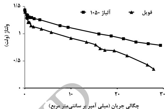
شکل ۵- مقایسه کارایی ورق آلیاژ آلومینیم شماره ۱۰۵۰ در مقایسه با فویل آلومینیمی چند لایه
