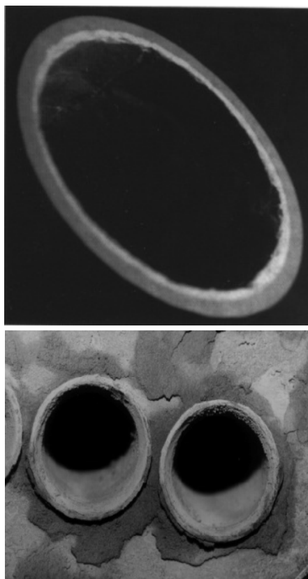
شکل ۵- نمونه‌هایی از رسوب گرفتگی ناشی از کری اور در تیوب‌های سوپرهیتر [۱]
