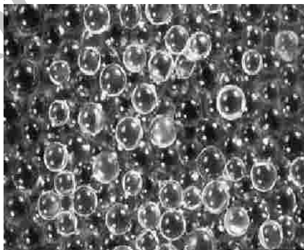
شکل ۴- کف کردن (ناشی از تشکیل حباب) بدلیل وجود نمک‌های قلیا در آب مخزن بخار [۱]
