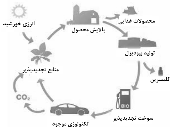
شکل ۱- چرخه اجمالی کربن خنثی بودن بیودیزل
