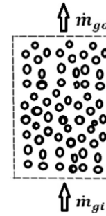
شکل ۱- نمای اجمالی خشک شدن مواد در خشک کن با بستر سیال ناپیوسته.
