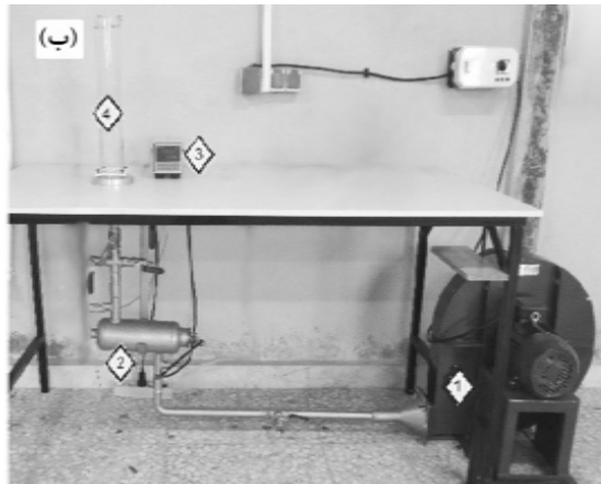
شکل ۲- (الف) نمای اجمالی و (ب) عکس خشککن پیشتاز ساخته شده جهت انجام آزمایشها (۱- دمنده ۲- گرم کننده ۳- کنترلر دما ۴- محفظه خشککن)
