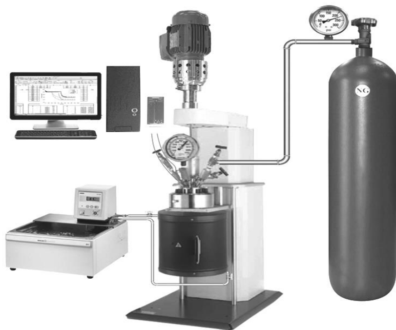
شکل ۵. شماتیک سامانه آزمایشگاهی فرایند تشکیل هیدرات.
