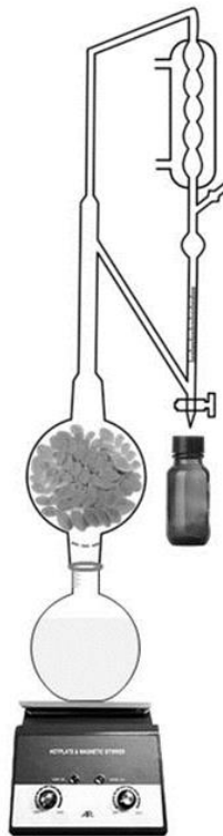
شکل ۲. دستگاه اسانس‌گیر کلونجر با روش تقطیر و استفاده از بخار و آب.
