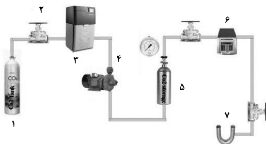
شکل ۱. طرحواره دستگاه استخراج به وسیله دی اکسید کربن فوق بحرانی با ترکیب امواج فراصوت
