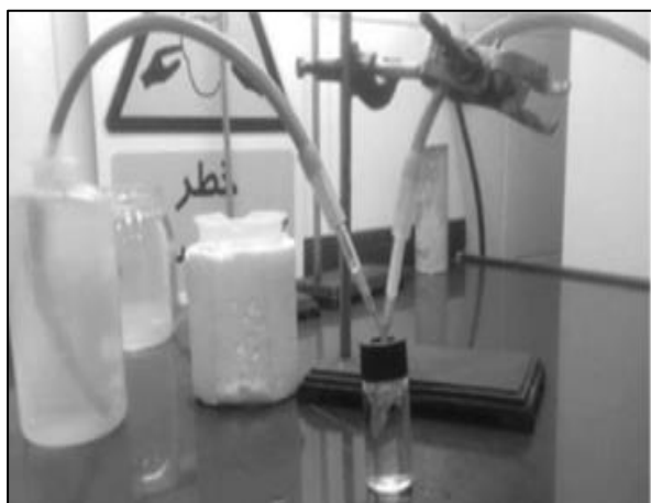
شکل ۱. سامانه حذف اکسیژن محلول با روش عبور گاز خنثی.
