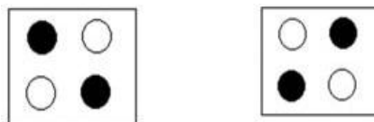
شکل ۲- دو حالت پایدار قرارگیری الکترون‌ها در سلول QCA [۱۶]
