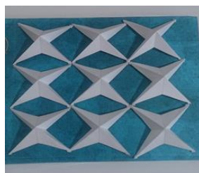
شکل ۹- نمونه مقوایی ساخته شده از ترسیمات در مقیاس کوچکتر جهت بررسی رفتار و قابلیت گسترش پذیری سازه
