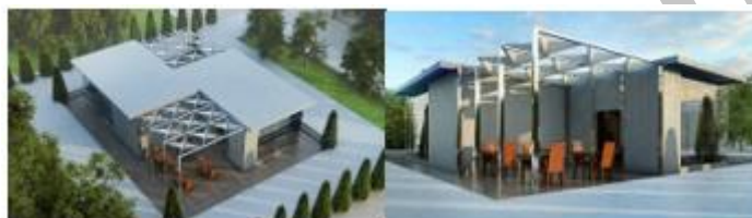
شکل ۱۸- مدل سه بعدی طرح تکمیلی یک رستوران که حالت های مختلف بازو بسته شدن سایه را به نمایش می گذارد
