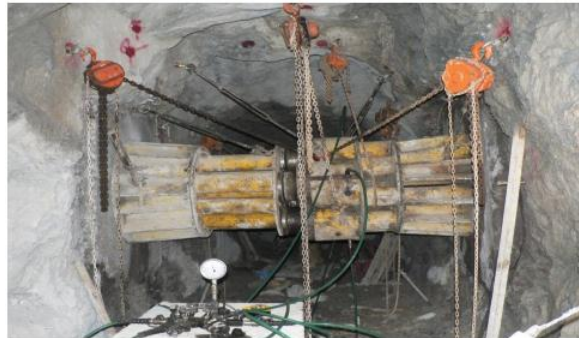
شکل ۳- نحوه اجرای آزمایش بارگذاری صفحه ای در گالری های اکتشافی ساختگاه سد چم شیر (مهتاب قدس، ۱۳۹۰)
