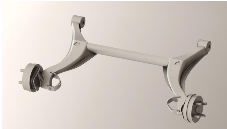
شکل ۱۰- نمای کلی از بدنه اکسل عقب خودروی تیا معمولی با پوش پلاستیکی
