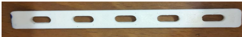
شکل ۷- فیکساتور تولید شده به روش تولید افزایشی
