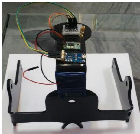
شکل ۳- نمونه الکتروگونیامتر نهایی شده جهت استفاده در مرکز درمانی
