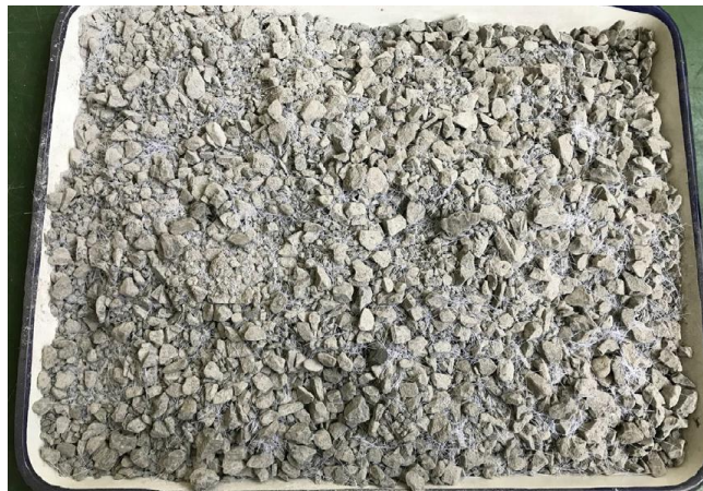
شکل ۳- اختلاط مصالح سنگی با سیم پلاستیکی ضایعاتی
