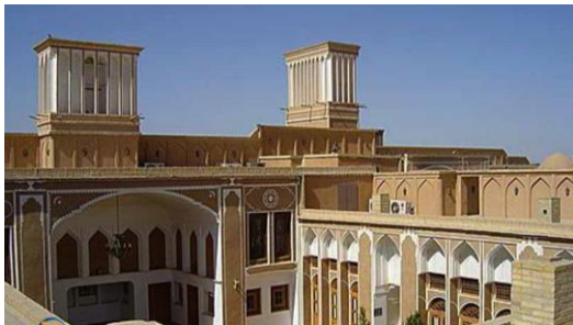
تصویر شماره ۲۱- بادگیرها و سایه‌ها در کنترل عوامل اقلیمی نقش دارند.
