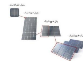
تصویر ۱۴- اجزا آرایه سیستم فتوولتاییک (جورسرایی آلاشتی، ۱۳۹۷)
