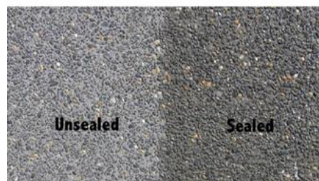
شکل ۲- پوشش نفوذگر کریستال شونده Aquafin IC (منبع: www.clinicetcon.com)
