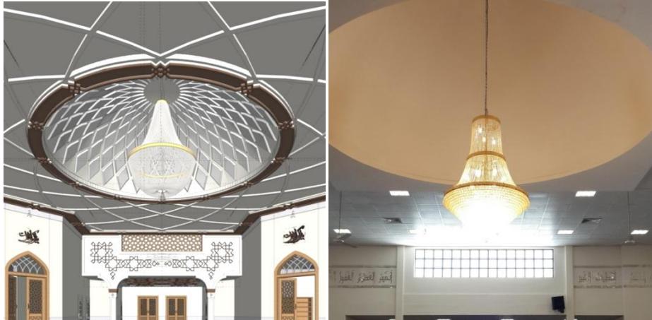
تصویر ۴- باز طراحی گنبد و سقف (سمت راست: وضعیت موجود گنبد و سقف. سمت چپ: گنبد و سقف باز طراحی شده) (منبع: نگارندگان)
