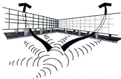
شکل ۲۰_ تخلیه سریع نیروهای انفجار از فضای پیلوت باز، ماخذ: (مبحث ۲۱ مقررات ملی ساختمان).
