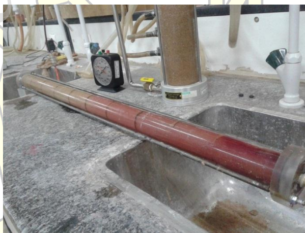
شکل (۷): لوله تزریق به طول ۱ متر و قطر ۴ سانتیمتر
