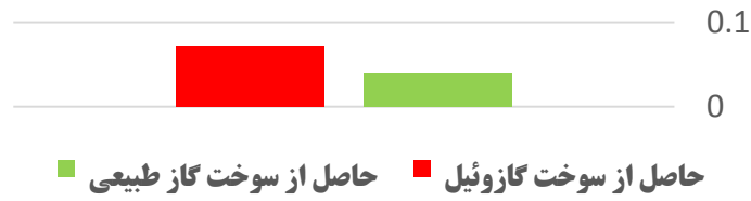
شکل (۳): مقایسه مقدار CO2 تولید شده در اثر سوخت گاز طبیعی و گازوئیل در زون نساجی (بر حسب کیلوگرم بر ثانیه در هکتار)
