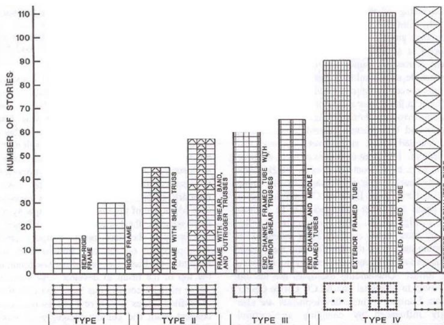
شکل ۱: سامانه‌های مهار جانبی برای تعداد طبقات مختلف [۵].
