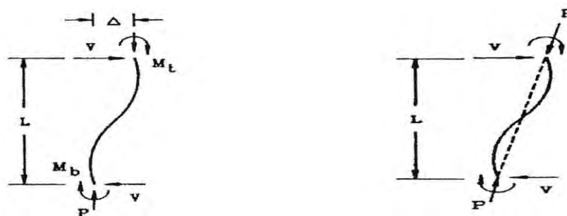
شکل ۱: نمودار تغییر مکان ستون تحت نیروی محوری الف- نمودار p - \delta ، ب- نمودار p - \Delta [۱].
