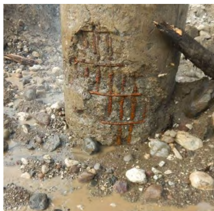
شکل ۲۱: خوردگی پایه پل مدل آزمایش.
