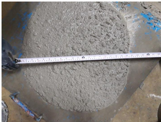
شکل ۳: آزمایش جریان اسلامپ.
