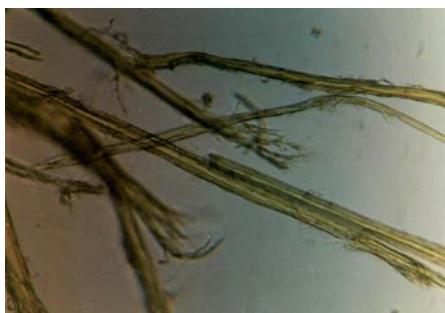
عکس شماره ۱۸- الیاف کنفی طبیعی کم کوبیده شده نمونه شاهد، رنگ آمیزی با معرف گراف C، بزرگنمایی ۱۰۰X.
