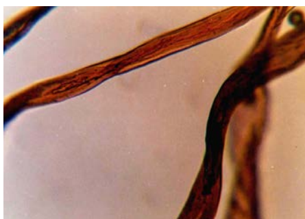
عکس شماره ۲۰- الیاف پنبه طبیعی نمونه شاهد، رنگ آمیزی با معرف هرزبرگ، بزرگنمایی ۲۰۰X.
