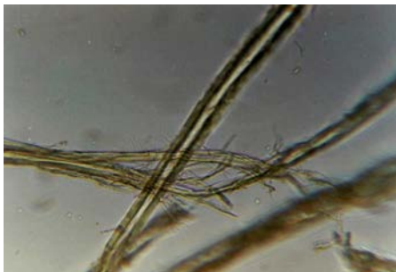
عکس شماره ۱۷- الیاف کنف طبیعی کوبیده شده نمونه شاهد، رنگ آمیزی با معرف هرزبرگ، بزرگنمایی ۲۰۰X.
