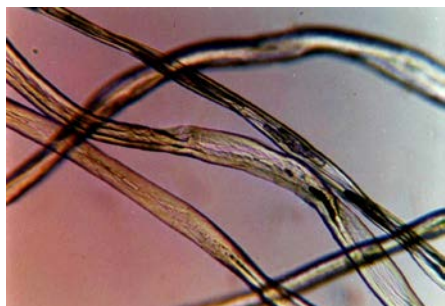
عکس شماره ۲۱- الیاف پنبه طبیعی نمونه شاهد، رنگ آمیزی با معرف گراف C، بزرگنمایی ۲۰۰X.
