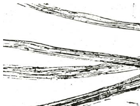
عکس شماره ۵- الیاف کتف طبیعی نمونه شاهد بزرگنمایی ۱۸۰X.
