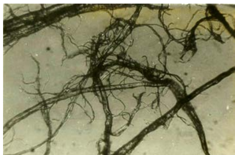
عکس شماره ۱- الیاف کاغذ قرآن نمونه ۱ بزرگنمایی X۱۵۰.
