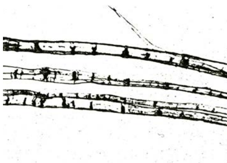
عکس شماره ۴- الیاف کتان طبیعی نمونه شاهد بزرگنمایی X۱۸۰.
