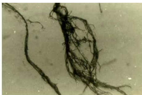
عکس شماره ۳- الیاف کاغذ قرآن نمونه ۲ بزرگنمایی X۱۵۰.
