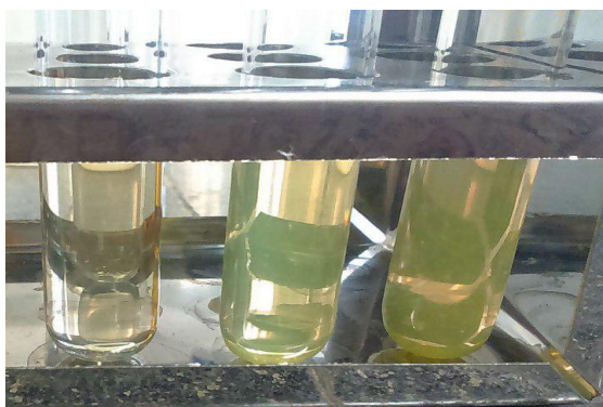
شکل 4: بررسی تخریب و حذف رنگینه سریلین زرد با استفاده از نانوذرات کلونیدی نقره
