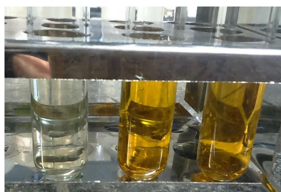
شکل 1: بررسی تخریب و حذف رنگینه متیل اورانژ با استفاده از نانوذرات کلونیدی نقره
