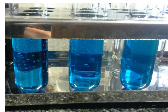
شکل 3: بررسی تخریب و حذف رنگینه متیل بلو با استفاده از نانوذرات کلونیدی نقره
