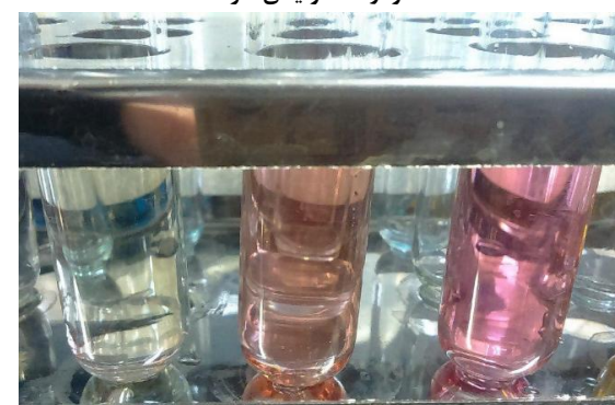
شکل 2: بررسی تخریب و حذف رنگینه متیل رد با استفاده از نانوذرات کلونیدی نقره
