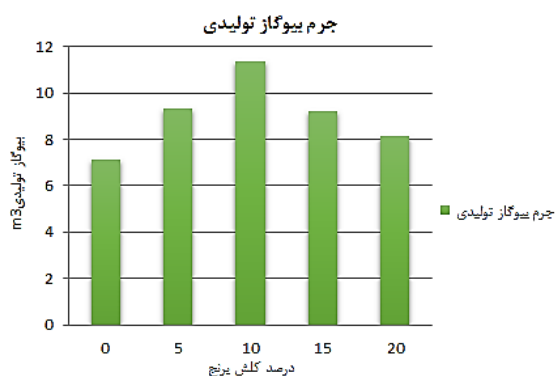
شکل ۱- میانگین تولید بیوگاز در نسبت‌های مختلف کلش برنج
