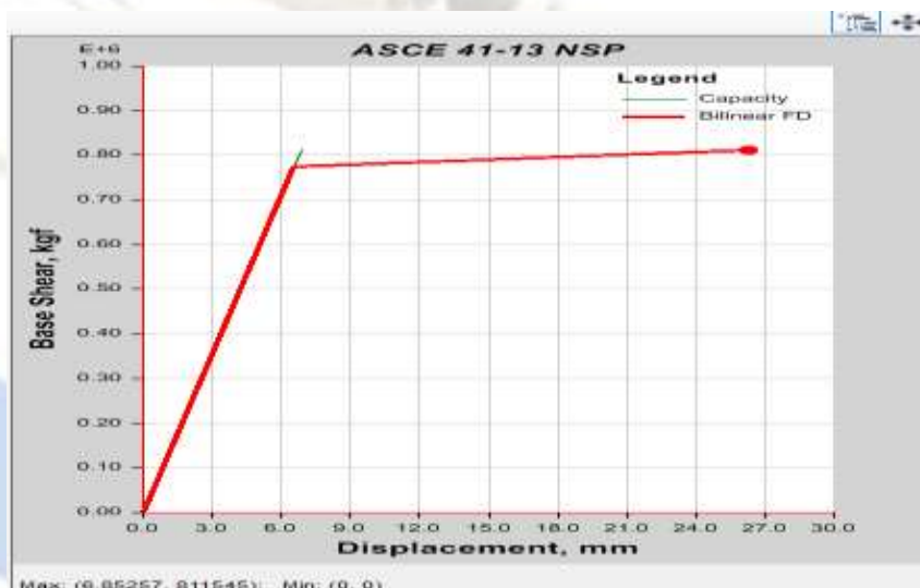
شکل شماره ۴- نمودار نیرو-جابجایی سازه مدل دوم در حالت بارگذاری یکنواخت
