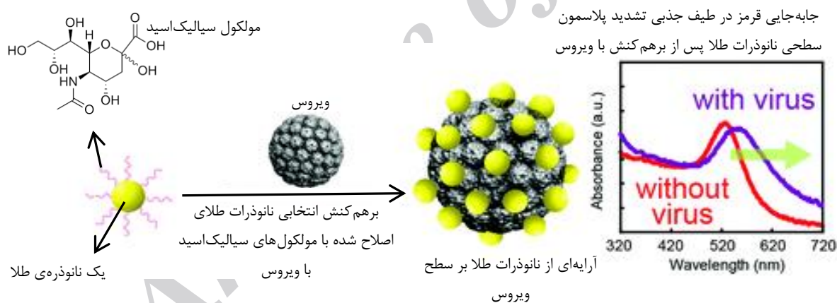
شکل ۴- حسگر نوری ویروس JC، با عامل تشخیصی کربوهیدرات پیوند شده بر سطح نانوذرات طلا با سازوکار انتقال علامت نوری از نوع تشدید پلاسمون سطحی (Niikura et al. 2009)
