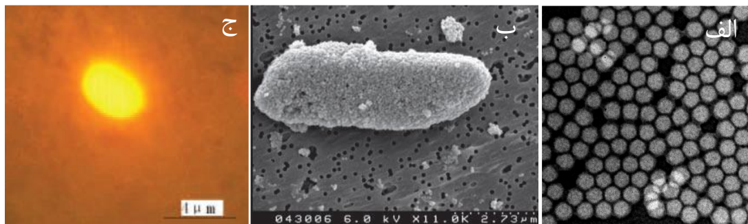
شکل ۳- (الف) تصویر میکروسکوپ الکترونی عبوری از نانوذرات سیلیکای آرایش شده با مولکول‌های فلئوئورسان، (ب) یک سلول E. Coli در محیط آبی محتوی نانوذرات پیوند شده با آنتی‌بادی، (ج) تصویر میکروسکوپ فلئوئورسانسی از یک سلول E. Coli در محیط آبی محتوی نانوذرات سیلیکا/آنتی‌بادی (Zhao et al. 2004).
