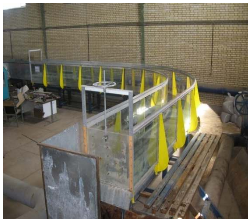
شکل ۱- فلوم مورد استفاده جهت مدل سازی ها
