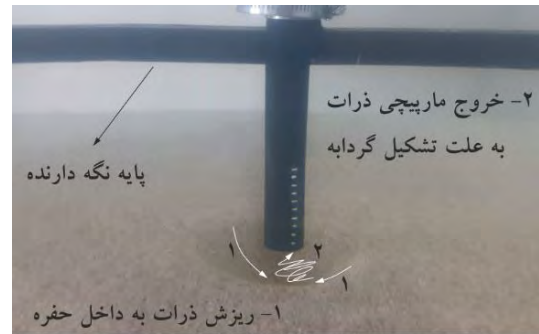
شکل ۴- تشکیل گردابه‌ها در زیر دهانه مکش ( F_r = 4/15 ) و Z/d = 0
