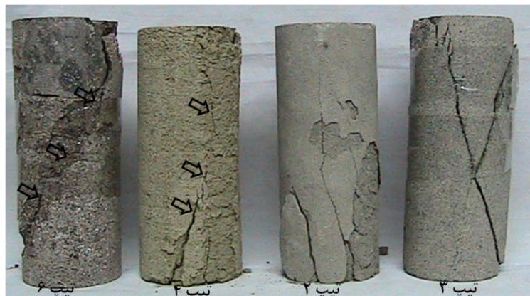
شکل ۴. برخی از نمونه‌های ماسه‌سنگ شکسته شده در آزمایش فشاری تک‌محوری در پایان ۳۰ چرخه آزمایش انجماد و ذوب
