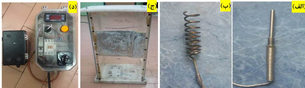
شکل ۸. نمایی کلی از تجهیزات اعمال دما به همراه محفظه‌ی دما: (الف) ترموکوپل الکتریکی، (ب) المنت الکتریکی، (ج) محفظه‌ی دما، (د) کنداکتور به همراه دماسنج دیجیتال
