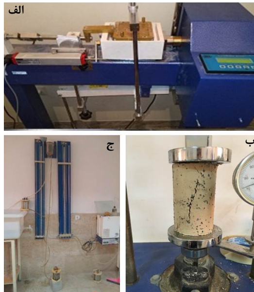
شکل ۴. تصویری از آزمون‌های صورت گرفته بر روی مصالح مورد مطالعه: الف- آزمون برش مستقیم ب- آزمون تک محوری، ج- آزمون نفوذپذیری با ارتفاع متغیر
