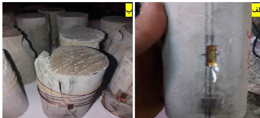
شکل ۷. نمونه‌های استوانه‌ای به کار رفته برای تعیین مدول الاستیسیته (الف) کرنش سنج نصب شده بر روی نمونه (ب) نمونه‌های شکسته شده پس از آزمایش
