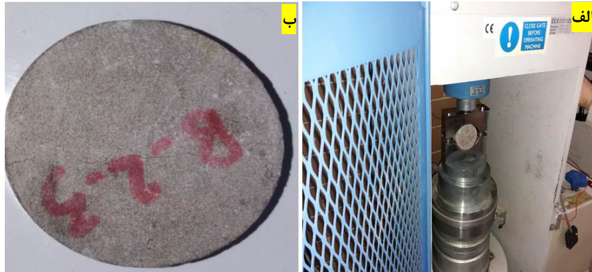
شکل ۹. آزمایش برزیلی (الف) نمونه تحت بارگذاری (ب) نمونه ترک‌خورده پس از انجام آزمایش
