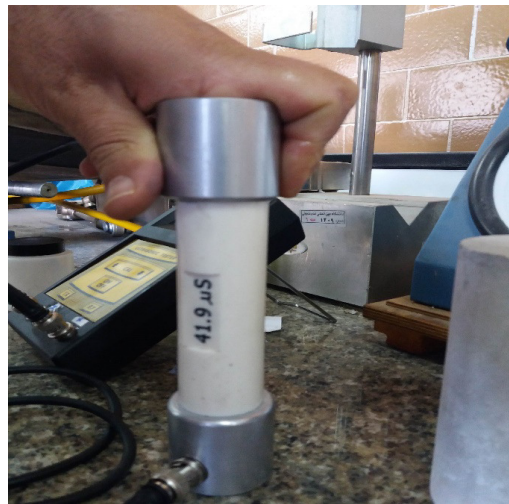
شکل ۳. کالیبره کردن دستگاه آزمایش تعیین سرعت امواج طولی
