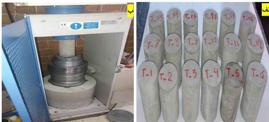
شکل ۵. آزمایش بارگذاری تک‌محوره (الف) تعدادی از نمونه‌های آماده شده (ب) نمونه تحت بارگذاری
