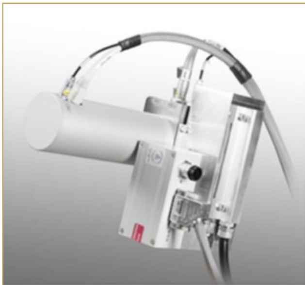
شکل ۱: تصویری از آشکارساز خلاء پایین در میکروسکوپ الکترونی [۶].
