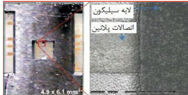
شکل (۱۰): تصویر نمای کلی تراشه میکرو سوئیچ (سمت چپ) و تصویر اتصال لایه سیلیکونی به پایه پلاتینی (سمت راست) [۵].
