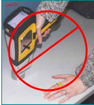
شکل (۹): روش نا ایمن کار با دستگاه آنالیز به علت قرار دادن دست روی میز [۲ و ۳].
