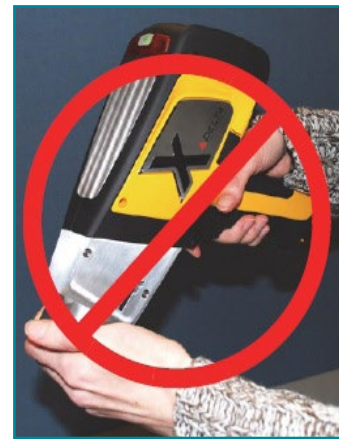
شکل (۷): روش نا ایمن کار با دستگاه آنالیز به علت نگاه داشتن نمونه در دست و عدم استفاده از دوزیمتر انگشتی و عدم پوشش کامل نمونه کار [۲ و ۳].
