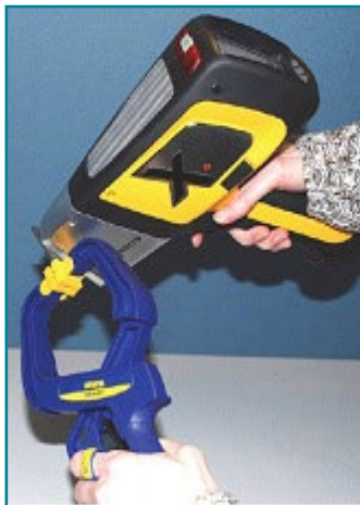
شکل (۱۰): استفاده از انبر مخصوص برای آنالیز نمونه‌های کوچک [۲ و ۳].
