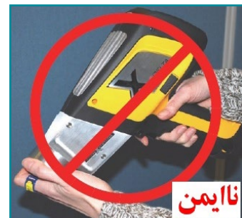
شکل (۸): روش نا ایمن کار با دستگاه آنالیز به علت نگاه داشتن نمونه در دست [۲ و ۳].
