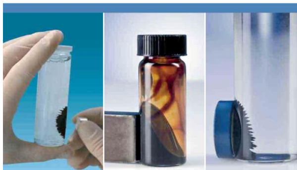
شکل ۵: سیالات مغناطیسی نانویی و میدان مغناطیسی
