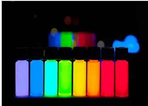
شکل ۲: نقاط کوانتومی با رنگ‌های بسیار روشن از بنفش تا قرمز که در آزمایشگاه‌های شیمی و پلاسما تولید می‌شوند.
