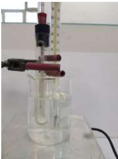
شکل ۱- حمام آب به همراه لوله قطور حاوی پنتادکانوئیک اسید و پالمیتیک اسید
