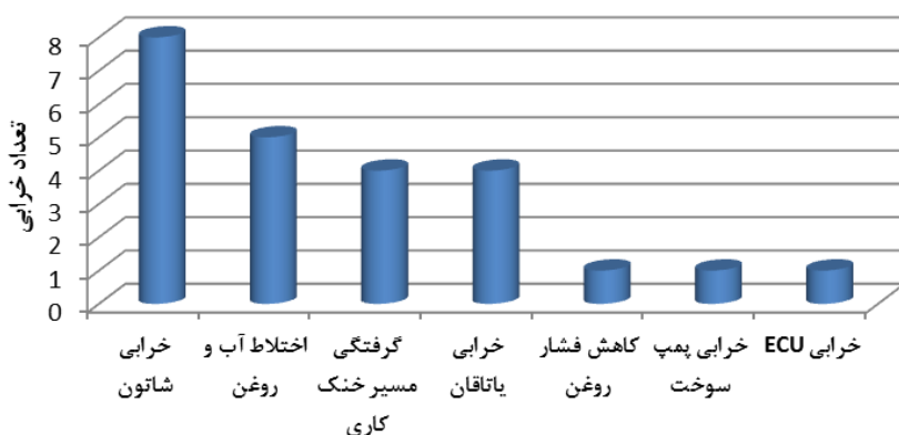
شکل پنج - گزارش آماری انواع خرابی استخراج‌شده از سامانه CMMS
