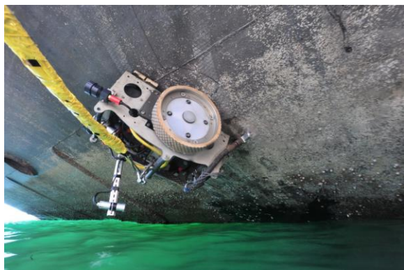
ربات بازرسی و تمیزکاری بدنه کشتی سیبرنتیک
