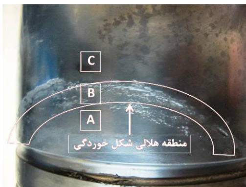
شکل ۴- ایجاد منطقه هلالی شکل خورده شده در قسمت انتهایی استوانه موتور دیزل دریایی
