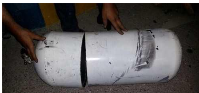
شکل (۴): انفجار مخزن گاز سی.ان.جی خودروی سمند، خوراسگان، ۱۳۹۴ (علت انفجار: استفاده از مخزن غیر استاندارد)
