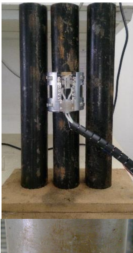
شکل ۱۳: (بالا) نمایی از مجموعه شبیه ساز لوله های واتروال بویلر همراه با نگهدارنده مکانیکی بر روی آن، (پایین) نمایی از دو حفره بر روی لوله میانی
