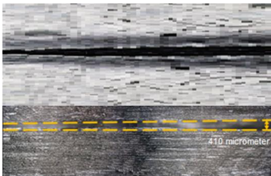
شکل ۹- تصویر تراهرتز (بالایی) و VMM (پایینی) برای نمونه‌ی سرامیکی لایه‌ای شده
