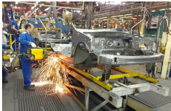
شکل ۱- جوش مقاومتی نقطه ای در بدنه خودرو تندرو ۹۰
